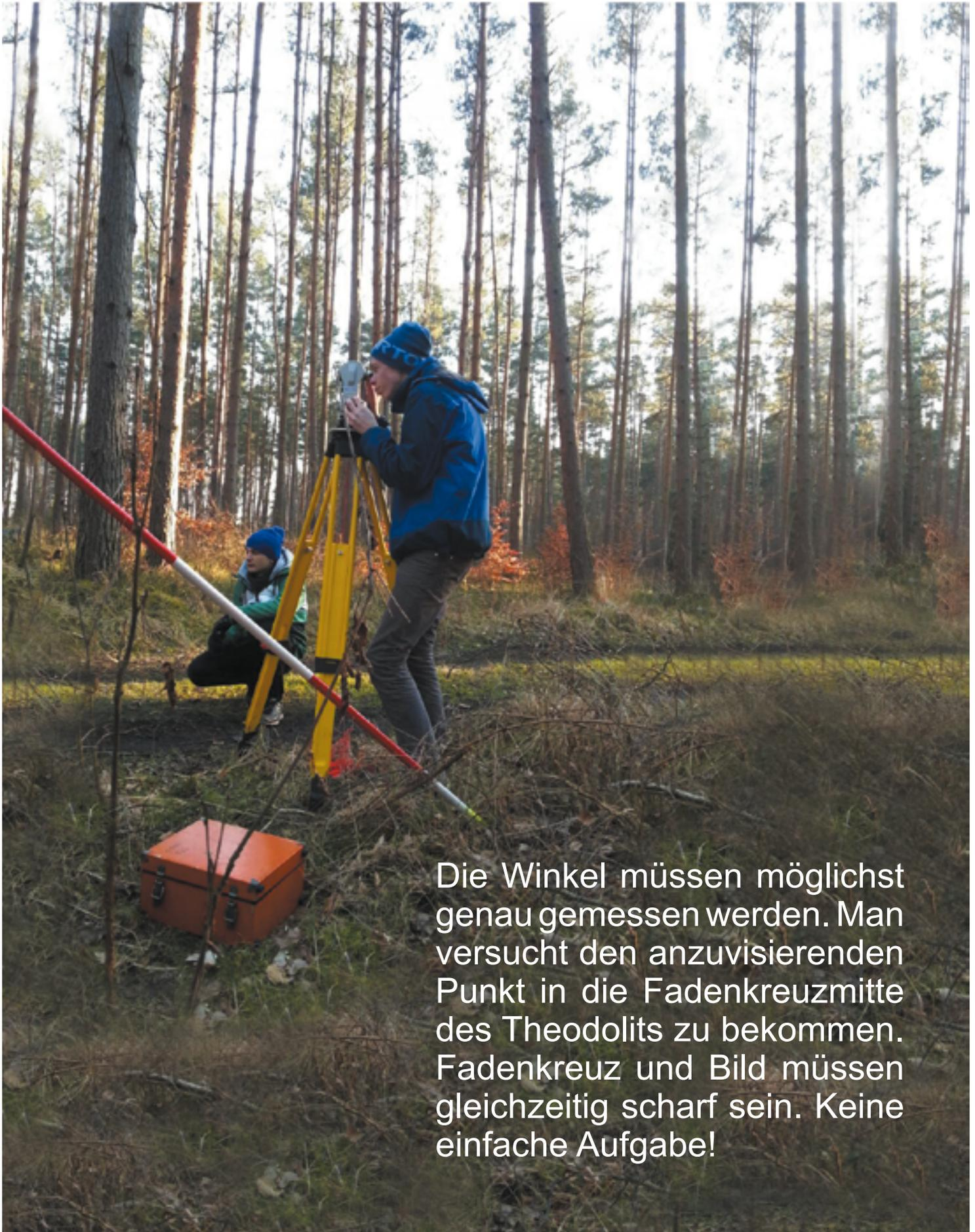
Die Winkel müssen möglichst genau gemessen werden. Man versucht den anzuvisierenden Punkt in die Fadenkreuzmitte des Theodolits zu bekommen. Fadenkreuz und Bild müssen gleichzeitig scharf sein. Keine einfache Aufgabe!
